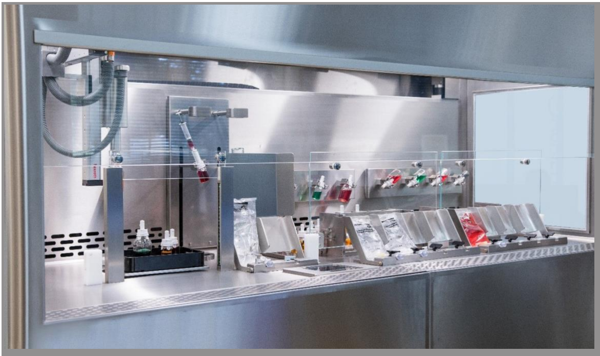
図5. ロボット薬剤調製システムは補助的なコントロールと考えられる。
